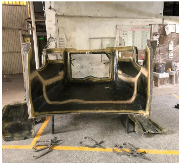
Figura 11: colocación de refuerzos
