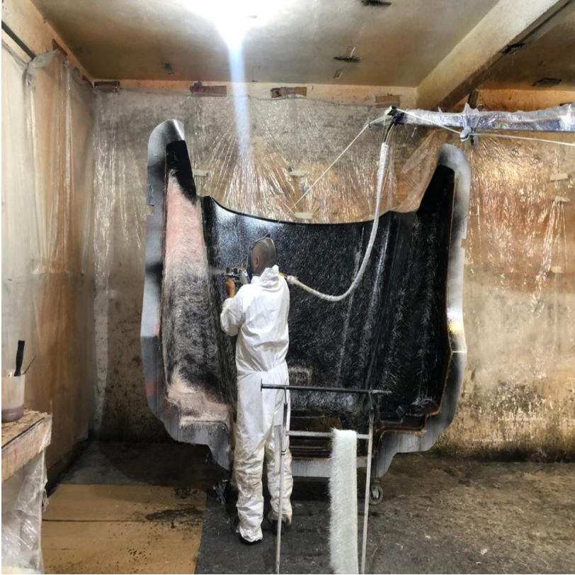
Figura 10: laminado de cofres
